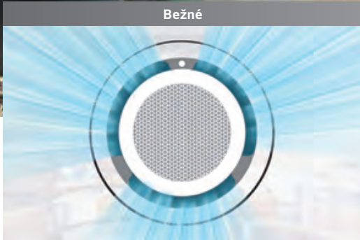
Třicestné proudění vzduchu se slepým bodem.
